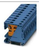
N-Trennklemme, zur Neutralleiter-Trennung, Schraubanschluss, Querschnitt: 6 mm² - 25 mm², AWG: 10 - 4, Breite: 12,2 mm, Farbe: blau, Montageart: NS 35/7,5, NS 35/15
