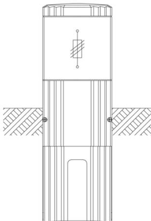
**Hausanschlusssäule, rund, 1x3NH2, Zug. V-Kl. 35-240mm<sup>2</sup> se, Abg. Bockkl. 25-95 Cu**
