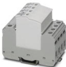
Steckbarer Überspannungsableiter, gem. Typ 2 / Class II, für 3-phasige Stromversorgungsnetze mit separatem N und PE (5-Leitersystem: L1, L2, L3, N, PE), mit Fernmeldekontakt. Für den Speisepunkt der Anlage mit erhöhtem Ableitvermögen nach VDE 0100-534:2016-10.
