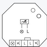
**Ohne N-Anschluss, Power MOSFET bis 200W. Stand-by-Verlust nur 0,5 Watt. Mit Steuereingängen für Lichttaster und Lichtschalter. Mindesthelligkeit, Betriebsart und Dimmgeschwindigkeit einstellbar.**
