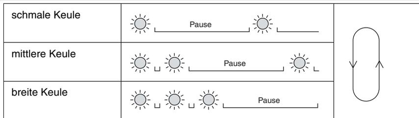
Mit dem Drücken der Taste A1 für 2 Sekunden wird die gewählte Keulenform gespeichert, der Parametrierprozess abgeschlossen und der Sensor kehrt in den Normalmodus zurück. Drücken Sie die Taste A1 stattdessen nur kurz, so gelangen Sie zurück in Stufe 1 (Parametrierung der Ausgangsfunktion).
