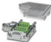
D-SUB-Stecker, 9-polige Buchse, eine Kabelzuführung unter 35°, Universaltyp für alle Systeme, Pinbelegung: 1, 2, 3, 4, 5, 6, 7, 8, 9 auf Schraubanschlussklemme
