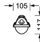
Leuchte höherer Schutzart; Gehäuse aus glasfaserverstärktem Polyester, mit alterungsbeständiger PUR-Schaum-Dichtung im umlaufenden Rand, Wannenclipse aus Edelstahl, Geräteträger aus weiß lackiertem Stahlblech. Gehäusefarbe hellgrau; Tiefgezogene Polycarbonatwanne mit opaler, glatter Oberfläche;
