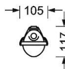
Leuchte höherer Schutzart; Gehäuse aus glasfaserverstärktem Polyester, mit alterungsbeständiger PUR-Schaum-Dichtung im umlaufenden Rand, Wannenclipse aus Edelstahl, Geräteträger aus weiß lackiertem Stahlblech. Gehäusefarbe hellgrau; Tiefgezogene Acrylglaswanne mit opaler, glatter Oberfläche; Treiber integriert. Elektrischer Anschluss über 3-polige Anschlussklemme in Steckkontakt-Technik.
