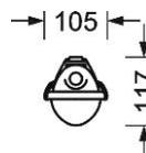
Leuchte höherer Schutzart; Gehäuse aus glasfaserverstärktem Polyester, mit alterungsbeständiger PUR-Schaum-Dichtung im umlaufenden Rand, Wannenclipse aus Edelstahl, Geräteträger aus weiß lackiertem Stahlblech. Gehäusefarbe hellgrau; Tiefgezogene Acrylglaswanne mit opaler, glatter Oberfläche; Treiber integriert. Elektrischer Anschluss über 5-polige Anschlussklemme in Steckkontakt-Technik.
