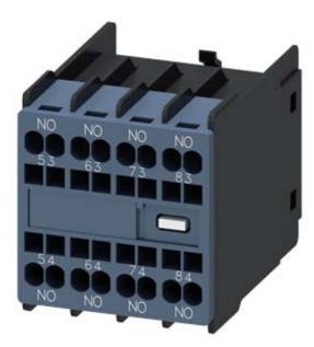
Hilfsschalter frontseitig, 4 S Strombahn 1 S, 1 S, 1 S, 1 S für Hilfsschütze Baugröße S00 Federzuganschluss 53/54, 63/64, 73/74, 83/84 physisch kodiert; nur mit HiSchützen  $3RH2140^*$  u  $3RH2440^*$  kombinierbar (nach EN 50011)
