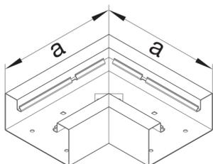
**Flachwinkel aus Grundprofil zu BRS 100x130mm OT 80mm aus Stahlblech verzinkt**
