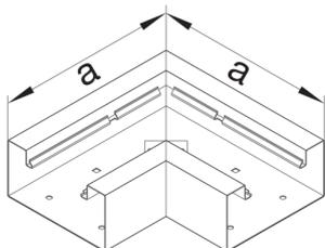
**Flachwinkel aus Grundprofil zu BRS 100x210mm OT 80mm aus Stahlblech verzinkt**
