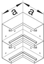
**Inneneck aus Grundprofil Stahlblech zu BRS 70x210mm Oberteil 2x80mm verzinkt**
