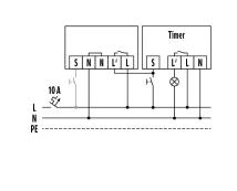
$Standard betrieb \ mit\ optionaler\ Ansteuerung\ durch\ Schließ taster\ und\ Parallels chaltung\ von\ max.\ 10\ Ger\"{a}ten$
