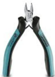
Elektronik-Seitenschneider, spitzer Kopf, abgewinkelt (21°), ohne Fase, mit Öffnungsfeder
