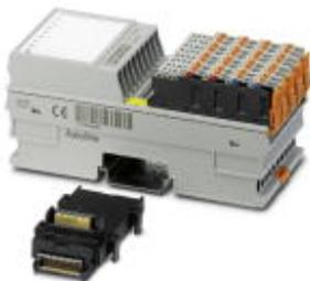
Axioline F, Analogausgabemodul, Analoge Ausgänge: 8, 0 V ... 5 V, -5 V ... 5 V, 0 V ... 10 V, -10 V ... 10 V, 0 mA ... 20 mA, 4 mA ... 20 mA, -20 mA ... 20 mA, Anschlusstechnik: 2-Leiter, Übertragungsgeschwindigkeit im Lokalbus: 100 MBit/s, Schutzart: IP20, inklusive Bussockelmodul und Axioline F-Steckern
