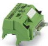
V8-Adapter für 8 x PLC-INTERFACE (6,2 mm); Steuerung: SPS-Systemverkabelung von Ausgangskarten; Anschluss 1: Steckanschluss; Anschluss 2: 1x IDC/FLK-Stiftleiste (14-polig); Anzahl der Kanäle: 8; Ansteuerlogik: minusschaltend
