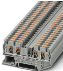
Durchgangsklemme, Nennspannung: 800 V, Nennstrom: 32 A, Anschlussart: Push-in-Anschluss, Anzahl der Anschlüsse: 4, Querschnitt: 0,2 mm<sup>2</sup> - 6 mm<sup>2</sup>, AWG: 24 - 10, Breite: 6,2 mm, Höhe: 35,3 mm, Farbe: grau, Montageart: NS 35/7,5, NS 35/15
