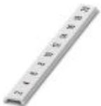
Zackband flach, Streifen, weiß, beschriftet, längs bedruckt: fortlaufende Zahlen 2-20, 22-40, usw. bis 82-100, Montageart: verrasten in flacher Schildchennut, für Klemmenbreite: 6,2 mm, Schriftfeldgröße: 5,15 x 6,15 mm
