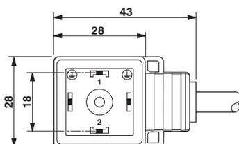
Ventilstecker, Bauform A
