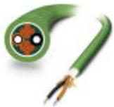
Konfektionierbare, hochflexible POF-PROFINETleitung für den Einsatz in Schleppketten für eine Wechselbiegehäufigkeit von bis zu 5 Mio. Zyklen. Einzelelemente aus hochstrapazierfähigem Polyamid (PE). Die Leitung ist halogenfrei, Ozon- und UV-beständig, mit robustem Polyurethan (PUR) Außenmantel.
