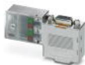
D-SUB-Stecker, 9-polig, Stift, Kabelzuführung unter 90°, Bussystem: PROFIBUS DP bis 12 MBit/s mit PG-D-SUB-Buchse zum Anschluss eines Programmiergeräts, Abschlusswiderstand ü. Schiebeschalter zuschaltbar, Pinbelegung: 3, 5, 6, 8; Schraubanschlussklemmen
