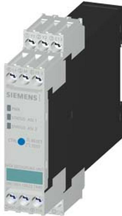
AS-i Datenentkoppler 2 x 4 A Schraubklemmen, AS-i doppel Datenentkopplungsmodul IP20, SlimLine S22,5 Schraubklemmen Baubreite Modul 22,5 mm IN: DC 24 V / 30 V OUT: 2 x AS-I, 4 A integrierter Überlastschutz integrierte Erdschlusserkennung Meldekontakt Fernreset
