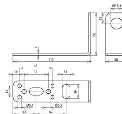
Geeignet für die Montage eines DEHNgate, Art.-Nr. 929 043 - 929 045. Bohrung Ø16 mm mit Verdrehenschutz.
