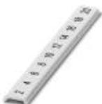
Zackband flach, Streifen, weiß, beschriftet, längs bedruckt: fortlaufende Zahlen 2-20, 22-40, usw. bis 82-100, Montageart: verrasten in flacher Schildchennut, für Klemmenbreite: 5 mm, Schriftfeldgröße: 5,15 x 5,15 mm
