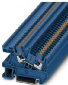
Installationsklemme, Push-in-Anschluss, Querschnitt: 0,14 mm<sup>2</sup> - 4 mm<sup>2</sup>, AWG: 26 - 12, Breite: 5,2 mm, Farbe: blau, Montageart: NS 35/7,5, NS 35/15
