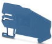
Auflagebock, Halterung für Sammelschienen, alle 20 cm zu setzen, Rastermaß: 200 mm, Länge: 69,25 mm, Breite: 2 mm, Höhe: 44,8 mm, Polzahl: 1, Farbe: blau
