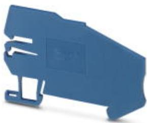
Auflagebock, Halterung für Sammelschienen, alle 20 cm zu setzen, Rastermaß: 200 mm, Länge: 69,25 mm, Breite: 2 mm, Höhe: 44,8 mm, Polzahl: 1, Farbe: blau
