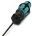
Drehmomentschraubendreher, mit voreingestelltem Drehmoment von 0,8 Nm, mit 4 mm Sechskant zur Aufnahme von SAC-Bits, Zwei-Komponentengriff, mit Abrollschutz
