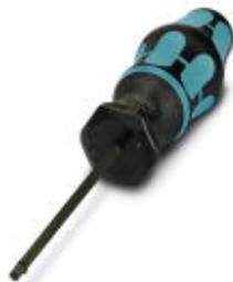
Drehmomentschraubendreher, mit voreingestelltem Drehmoment von 0,8 Nm, mit 4 mm Sechskant zur Aufnahme von SAC-Bits, Zwei-Komponentengriff, mit Abrollschutz
