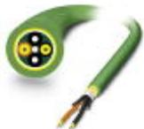
Konfektionierbare PROFINET HCS-GI-Installationsleitung (nur IP20-Köpfe), für Schleppketten geeignet, für Verlegung im Innenbereich, Gradientenindexfaser. Einzelelemente aus hochflexiblem FRNC-Material. Halogenfrei, Ozon- und UV-beständig mit Polyurethan-(PUR)-Außenmantel.
