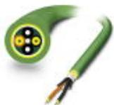
PROFINET-HCS-GI-Faserkabel, duplex 200/230  $\mu\text{m}$ , erhöhte Bandbreite speziell für Ethernet-Applikationen. Robuster PUR-Außenmantel. Schwere Ausführung, Schleppketten geeignet, für Verlegung im Innenbereich, Meterware ohne Stecker
