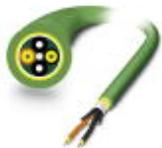
Konfektionierbare PROFINET HCS-GI-Installationsleitung für die feste Verlegung im Innenbereich, mit Gradientenindexfaser für höchste Leistungsansprüche, sowie Einzelelemente aus hochflexiblem FRNC-Material. Die Leitung ist halogenfrei, Ozon- und UV-beständig mit robustem Polyurethan (PUR) Außenmantel.
