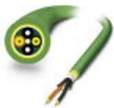
Konfektionierbare PROFINET HCS-GI-Installationsleitung (nur IP20-Köpfe), für Schleppketten geeignet, für Verlegung im Innenbereich, Gradientenindexfaser. Einzelelemente aus hochflexiblem FRNC-Material. Halogenfrei, Ozon- und UV-beständig mit Polyurethan-(PUR)-Außenmantel.
