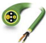
PROFINET-HCS-GI-Faserkabel, duplex 200/230  $\mu\text{m}$ , erhöhte Bandbreite speziell für Ethernet-Applikationen. Robuster PUR-Aussenmantel. Schwere Ausführung, Schleppketten geeignet, für Verlegung im Innenbereich, Meterware ohne Stecker
