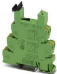
14 mm PLC-Grundklemme für hohe Dauerströme mit Push-in-Anschluss, ohne Relais- oder Solid-State-Relaisbestückung, zur Montage auf Tragschiene NS 35/7,5, 1 Wechsler, Eingangsspannung 24 V DC
