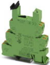
14 mm PLC-Grundklemme mit Push-in-Anschluss, ohne Relais- oder Solid-State-Relaisbestückung, zur Montage auf Tragschiene NS 35/7,5, 2 Wechsler, Eingangsspannung 24 V DC
