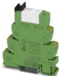
PLC-INTERFACE, bestehend aus Grundklemme PLC-BPT.../21-21 mit Push-in-Anschluss und steckbarem Miniaturrelais mit Mehrlagen-Goldkontakt, zur Montage auf Tragschiene NS 35/7,5, 2 Wechsler, Eingangsspannung 12 V DC
