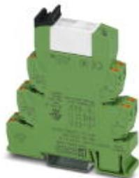
PLC-INTERFACE, bestehend aus Grundklemme PLC-BPT.../21-21 mit Push-in-Anschluss und steckbarem Miniaturrelais mit Mehrlagen-Goldkontakt, zur Montage auf Tragschiene NS 35/7,5, 2 Wechsler, Eingangsspannung 230 V AC/DC
