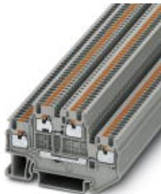
Doppelstockklemme, Anschlussart: Push-in-Anschluss, Querschnitt: 0,14 mm<sup>2</sup> - 1,5 mm<sup>2</sup>, AWG: 26 - 14, Breite: 3,5 mm, Farbe: grau, Montageart: NS 35/7,5, NS 35/15
