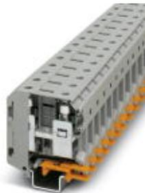
Hochstromklemme, Nennspannung: 1000 V, Nennstrom: 192 A, Anschlussart: Schraubanschluss, Anzahl der Anschlüsse: 2, Polzahl: 1, Querschnitt: 16 mm<sup>2</sup> - 95 mm<sup>2</sup>, AWG: 4 - 3/0, Breite: 20,3 mm, Höhe: 78,3 mm, Farbe: grau, Montageart: NS 35/7,5, NS 35/15, NS 35/15-2,3, NS 32
