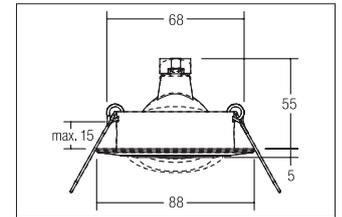
Einbaustrahler, GX5,3, chrom, rund. Ausgeführt in kompakter Bauform für werkzeuglose Schnellmontage zum Deckeneinbau-
