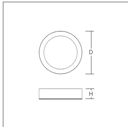
Anbaugehäuse. Für Einbau-Downlight Toledo Flat Round / D 495 mm. Deckengestell und Montageblech Metall verzinkt. Zylindergehäuse Stahlblech pulverbeschichtet. Downlight werkzeuglos verriegelbar.
