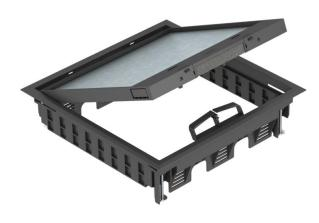
Geräteeinsatz mit Rastschieber für bis zu 12 Modul 45-Einzelgeräte in 3 Universalträgern UT4, Einsatz in Kanalsystemen und Systemböden im Innenbereich. Bodenbelagaussparung im Klappdeckel voreingestellt auf 5 mm, bei Bedarf auch einstellbar auf 10 mm.
