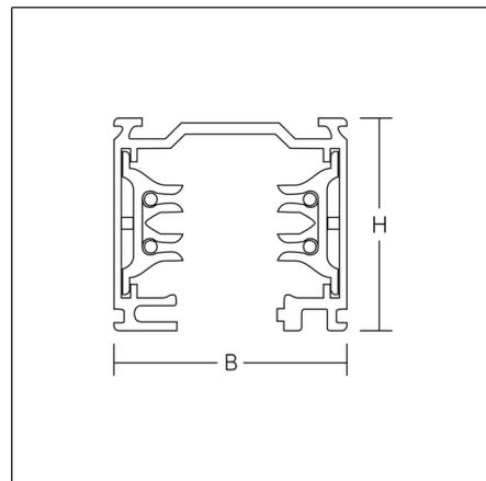
Aluminium-Strangpressprofil lackiert. Schienen beliebig ablängbar. Für den Handbereich zugelassen. Mit fünf Befestigungsbohrungen bei 100 mm, 990 mm, 1990 mm, 2990 mm und 3870 mm.
