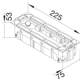
**Geräteträger f 4 Rastec 45 Geräte o 3 Tragstepper aus PA zu VQ12VR12/VR10(Mitte)**
