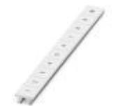
Zackband, Streifen, weiß, beschriftet, beschriftbar mit: CMS-P1-PLOTTER, längs bedruckt: fortlaufende Zahlen 1-10, 11-20 usw. bis 991-1000, Montageart: verrasten in hoher Schildchennut, für Klemmenbreite: 10,2 mm, Schriftfeldgröße: 10,15 x 10,5 mm
