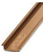
Tragschiene ungelocht, Standardprofil, Breite: 35 mm, Höhe: 7,5 mm, nach EN 60715: 2001, Material: Kupfer, unbeschichtet, Länge: 2000 mm, Farbe: kupferfarben
