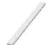
Zackband flach, Streifen, weiß, unbeschriftet, beschriftbar mit: CMS-P1-PLOTTER, PLOTMARK, Montageart: verrasten in flacher Schildchennut, für Klemmenbreite: 10 mm, Schriftfeldgröße: 5,15 x 10 mm
