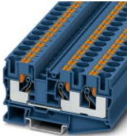
Durchgangsklemme, Nennspannung: 1000 V, Nennstrom: 57 A, Anschlussart: Push-in-Anschluss, Anzahl der Anschlüsse: 3, Querschnitt: 0,5 mm<sup>2</sup> - 16 mm<sup>2</sup>, AWG: 20 - 6, Breite: 10,2 mm, Höhe: 49,5 mm, Farbe: blau, Montageart: NS 35/7,5, NS 35/15
