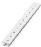
Zackband, Streifen, weiß, beschriftet, beschriftbar mit: CMS-P1-PLOTTER, quer bedruckt: fortlaufende Zahlen 1-10, 11-20 usw. bis 991-1000, Montageart: verrasten in hoher Schildchennut, für Klemmenbreite: 10,2 mm, Schriftfeldgröße: 10,15 x 10,5 mm
