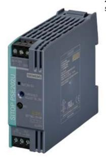
SITOP PSE202U NEC CLASS 2 SITOP PSE202U NEC Class 2 Redundanzmodul Eingang/Ausgang: 24 V DC geeignet zur Entkopplung zweier SITOP Stromversorgungen Ausgangsleistung begrenzt 100VA
