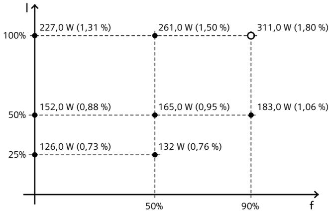
Die Prozentwerte geben die Verluste in Bezug auf die Bemessungscheinleistung des Umrichters an.
