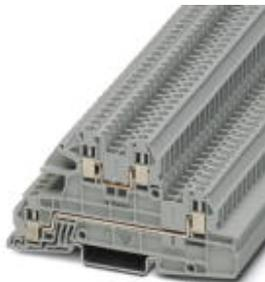
Installationsetagenklemme, Schraubanschluss, Querschnitt: 0,2 mm<sup>2</sup> - 4 mm<sup>2</sup>, AWG: 24 - 12, Breite: 5,2 mm, Farbe: grau, Montageart: NS 35/7,5, NS 35/15
