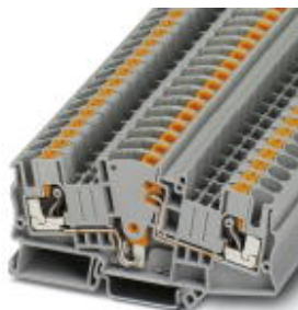
Messwandler-Trennklemme, Anschlussart: Push-in-Anschluss, Querschnitt: 0,5 mm 2 - 10 mm 2 , AWG: 20 - 10, Breite: 8,2 mm, Farbe: grau
