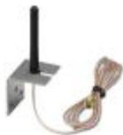
Rundstrahlantenne, 2,4 GHz, Gewinn: 2 dBi, Polarisierung: linear, Öffnungswinkel: h/v 360°/75°, Schutzart: IP65, Anschluss: RSMA (male), inkl. 1,5-m-Anschlusskabel und Montagewinkel für Wandmontage
