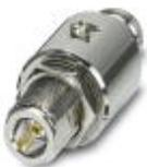
Antennenbarriere für die Schaltschrankdurchführung, Zündschutzart: Ex i, Schutzart: IP65, Installation Barriere: Zone 2, Installation Antenne: Zone 0, 1 oder 2, Frequenzbereich: 0,3 GHz ... 6 GHz, Anschluss: 2 x N (female), ATEX- und IECEx-Zulassung
