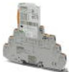
Überspannungsschutz, bestehend aus Schutzstecker und Basiselement, mit integrierter Statusanzeige und Messertrennung für drei Signaladern mit gemeinsamen Bezugspotenzial. Für HF-Anwendungen und Telekommunikationsschnittstellen ohne Speisespannung. Indirekte Erdung über Gasableiter.
