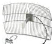
Richtantenne, 2,4 GHz, Gewinn: 19 dBi, Polarisation: linear, Öffnungswinkel: h/v 17°/11°, Schutzart: IP65, Anschluss: N (female), inkl. Montagewinkel und Mastschellen
