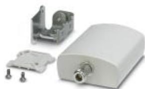
Richtantenne, 2,4 GHz / 5 GHz, Gewinn: 9 dBi, Polarisation: linear, Öffnungswinkel: h/v 75°/55°, Schutzart: IP67, seewasserbeständig, Anschluss: N (female), inkl. Montagewinkel und Mastschellen, ATEX- und IECEx-Zulassung
