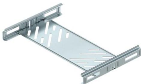
Kabelrinnenverbinder mit Schnellbefestigung für die schraubenlose Verbindung von gelochten Kabelrinnen mit der Seitenhöhe 35 mm. Durch die optimierte Bauform kann der Verbinder zur Herstellung von Radien und als Längenausgleichsstück bei großen Temperaturschwankungen eingesetzt werden.
