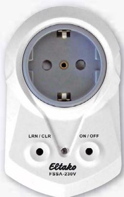
**1 Schließer nicht potenzialfrei 10A/250 V AC, Glühlampen 2000 Watt, ESL und LED bis 400 Watt. Verschlüsselter Funk, bidirektionaler Funk und Repeater-Funktion zuschaltbar. Stand-by-Verlust nur 0,8 Watt.**
